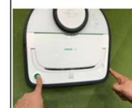
▶ロボット本体のWi-Fi設定をリセットするにはVR300の「電源ボタン」と「バンパー右横の手前部分」を同時に、各LEDが消えるまで数秒間長押しをする。
